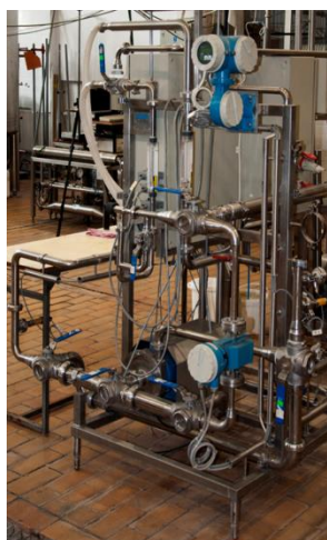
Fot. 3. Stanowisko do badań procesów separacji membranowej
