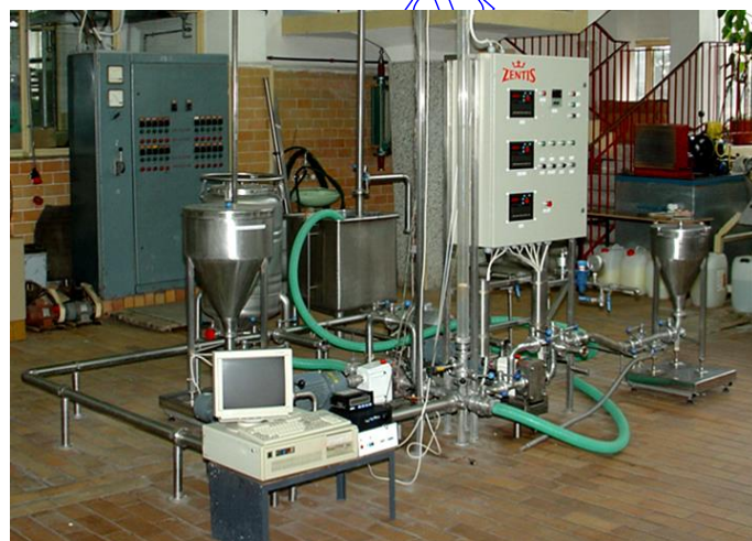
Fot. 2. Stanowisko do badań procesu mieszania cieczy w przepływie
