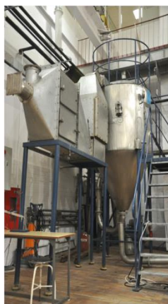
Fot. 5. Suszarnia rozpyłowa z dyskowym mechanizmem rozpylania
