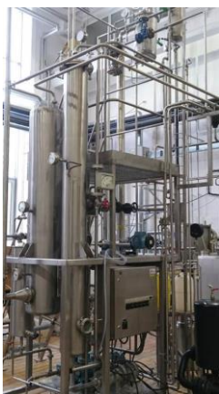
Fot. 4. Wyparka z opadającym filmem cieczy (FFE)
