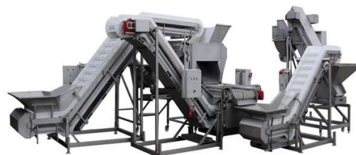
Linia do kalibrowania i naważania kalafiorów lub brokułów; Line for sorting and weighing cauliflower and broccoli
